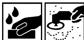
Nach Ablauf von 3,5-4,0 Stunden bei einer Temperatur von +20 °C können Defekte und Einschlüsse mit Schleifmitteln entfernt werden:
